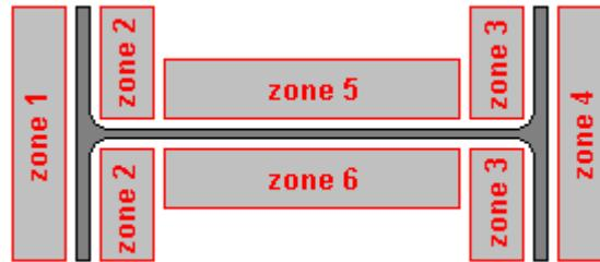
Ces zones sont représentées par un rectangle (ou 2 selon les cas). Un simple clic dans une zone permet sa sélection, le rectangle se dessine alors en rouge. Il se peut que certaines zones ne soient pas représentées. En effet, lorsque les distances minimales ne permettent pas l'utilisation de toutes les zones, PowerConnect désactive automatiquement les zones inutilisables.
