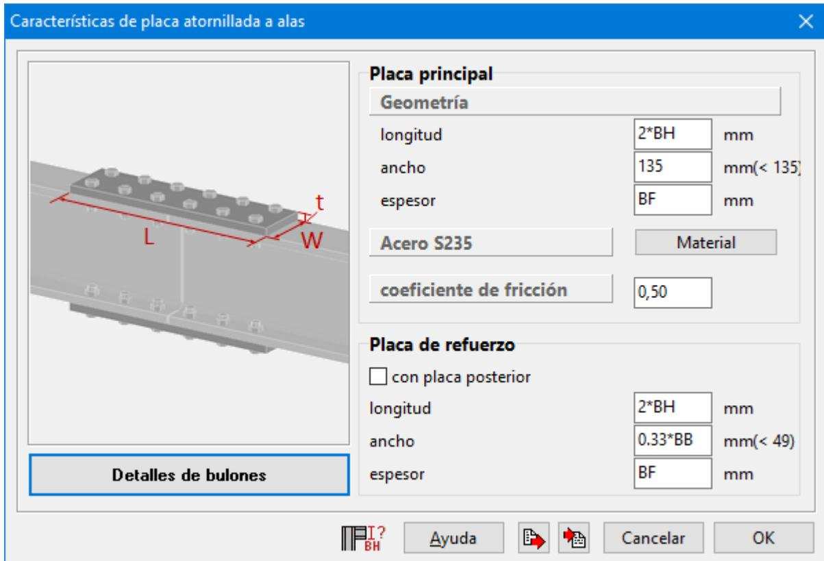
Las placas atornilladas en ala se usan básicamente para empalmes de vigas. Las placas de ala tienen que ser simétricas respecto al eje central del empalme.
