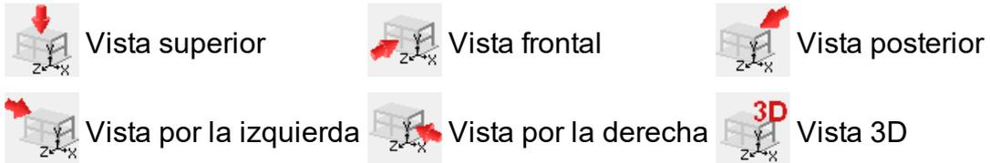
La vista seleccionada se aplica a todas las configuraciones dentro de la misma ventana. En otras palabras, cuando pasamos de una pantalla de configuración a otra ('Geometría', 'Cargas' y 'Resultados'), el modelo siempre está visible con la misma vista.
